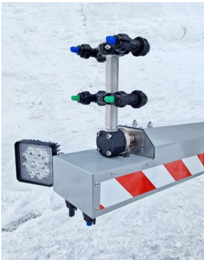
Barra de pulverización con pulverización doble, boquillas laterales y luz LED de trabajo
