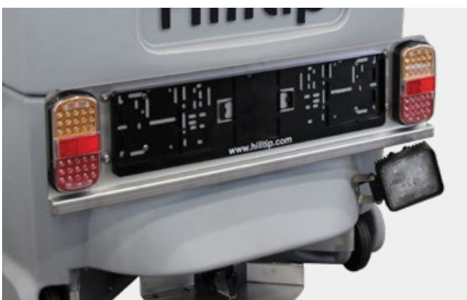
Luces LED traseras, kit de placa de matrícula y luz LED de trabajo
