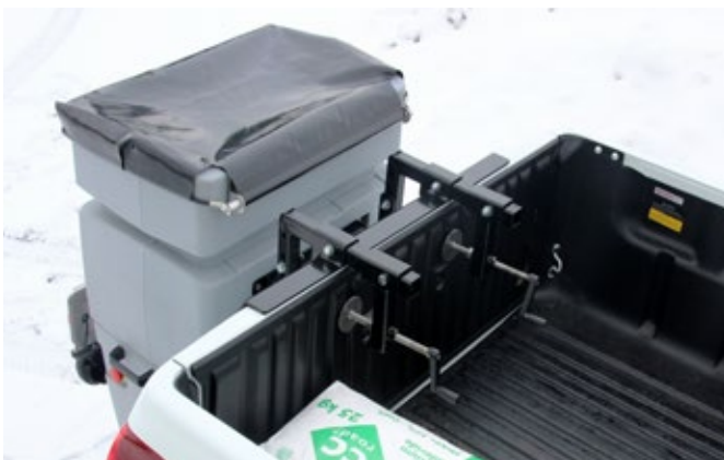
Montaje en puerta trasera de camioneta
